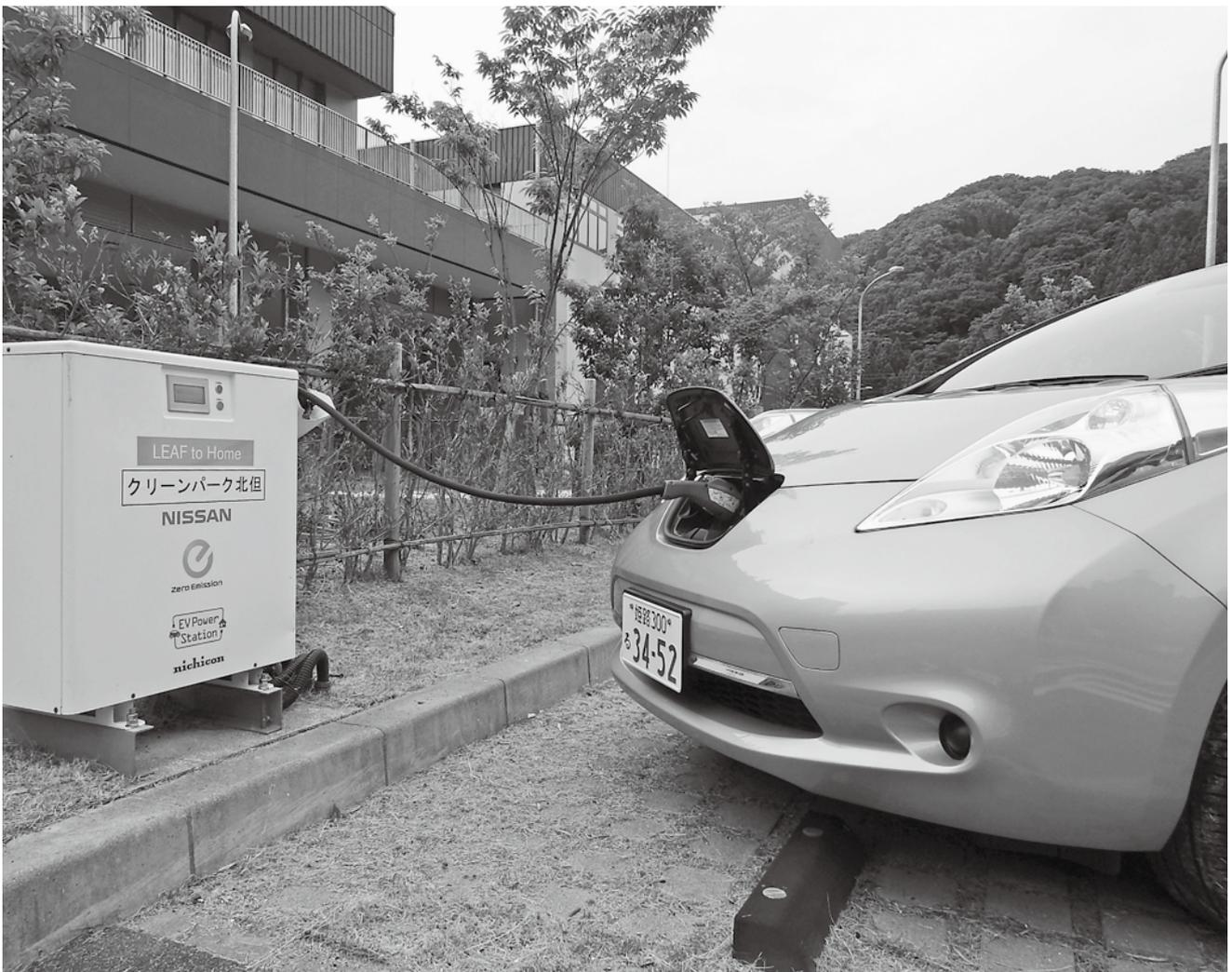
クリーンパーク北但では、ごみ焼却から発生する熱で発電を行い、その電力で動く電気自動車 (EV) と給電設備があります。ガソリンなどの化石燃料を使わないので二酸化炭素や窒素酸化物などの有害ガスの発生がなく、騒音も少ないことから「環境にやさしい」と注目されている技術です。
